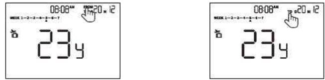
Das Symbol **FROM** zeigt an, dass Sie die Startzeit einstellen, das Symbol **TO** zeigt an, dass Sie die Endzeit einstellen; die Reihenfolge ist "Jahr-Monat-Tag-Stunde". Drücken Sie die Tasten , um den Wert einzustellen, und drücken Sie die Taste , um den Wert zu bestätigen und die nächste Option einzustellen; nach der Einstellung der Startzeit wird automatisch die Seite für die Einstellung der Endzeit aufgerufen. Drücken Sie die Taste , um zwischen **FROM** und **TO** zu wechseln.
